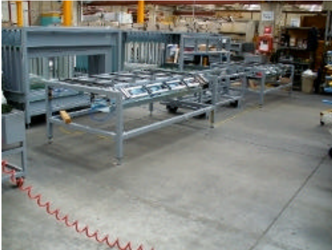
Banchi montaggio telai per porte
