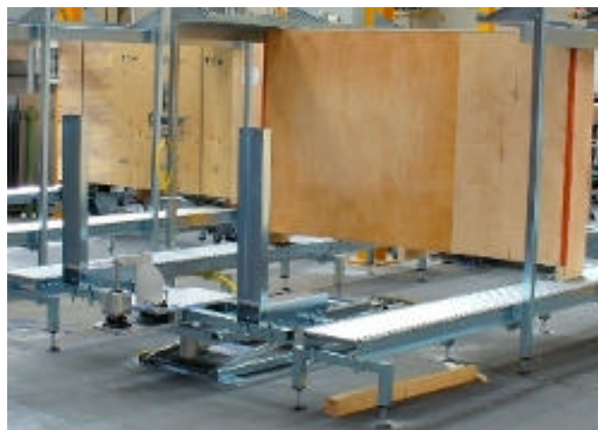
Magazzino casse vuote e banco montaggio casse
