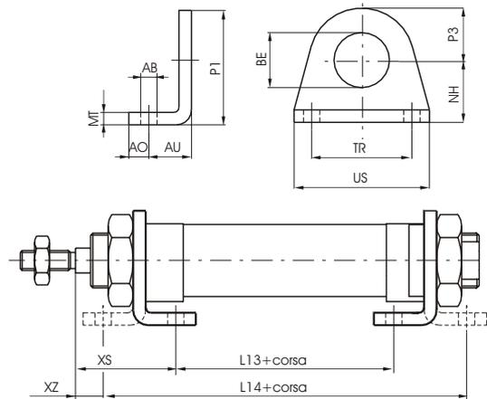
Dispositivo di ancoraggio su piano con l'asse dello stelo parallelo al piano stesso. Utilizzabile sia singolo per le corse corte, che in coppia per le corse lunghe. Realizzato in lamiera di acciaio inox AISI 304 tranciata e piegata. Viene fissato alle testate con l'ausilio dei dadi (o ghiera) 05X.
