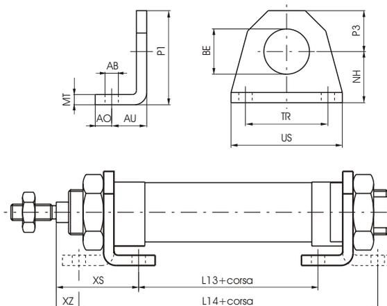
Dispositivo di ancoraggio su piano con l'asse dello stelo parallelo al piano stesso. Utilizzabile sia singolo per le corse corte, che in coppia per le corse lunghe. Realizzato in lamiera tranciata e piegata, è protetto contro la corrosione da un trattamento di cataforesi. Viene fissato alle testate con l'ausilio dei dadi (o ghiera) 05.
