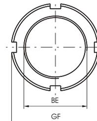
Servono a bloccare flange o piedini alle testate del microcilindro. I dadi sono montati sui diametri che vanno dall'8 al 25, le ghiera su 32, 40 e 50, entrambi vengono forniti di serie (1 pezzo) sui microcilindri.
