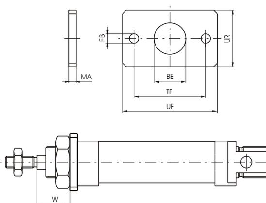
Elemento che permette l'ancoraggio dei microcilindri su un piano con l'asse dello stelo ortogonale al piano stesso. Si blocca alla testata anteriore (o posteriore) con un dado (o ghiera) 05. Realizzato in acciaio trafilato e protetto con cataforesi.
