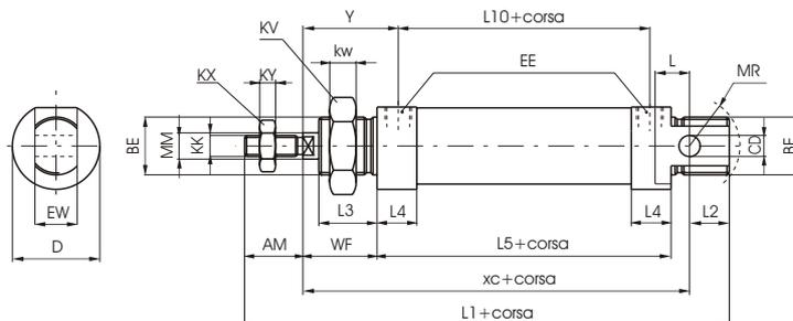
Esecuzione standard, perfettamente conforme alle norme ISO dal  $\varnothing$  8 al  $\varnothing$  25. I diametri 32, 40 e 50, non contemplati dalle norme, sono secondo nostre specifiche. Accetta tutti i tipi di ancoraggio previsti. Per i tipi a semplice effetto la corsa massima è di 40 mm., oltre la quale gli ingombri aumentano in lunghezza in maniera non proporzionale alla corsa (e comunque non oltre corsa 100).
