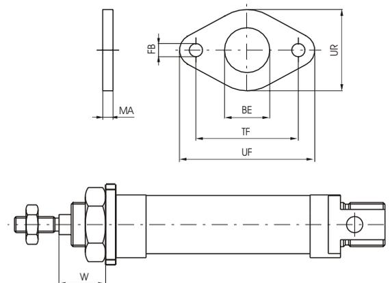
Elemento che permette l'ancoraggio dei microcilindri su un piano con l'asse dello stelo ortogonale al piano stesso. Si blocca alla testata anteriore (o posteriore) con un dado (o ghiera) 05X. Realizzato in acciaio inox AISI 304.
