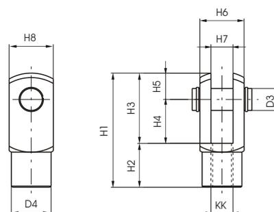
Come la cerniera 03X, montata sul filetto dello stelo, consente un funzionamento regolare anche in presenza di notevoli disassamenti delle forze applicate all'elemento collegato. E' realizzata in acciaio inox AISI 304.
