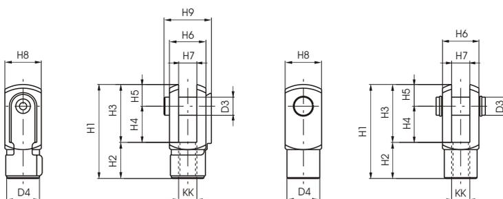
Come la cerniera 03, montata sul filetto dello stelo, consente un funzionamento regolare anche in presenza di notevoli disassamenti delle forze applicate all'elemento collegato. E' realizzata in acciaio zincato.
