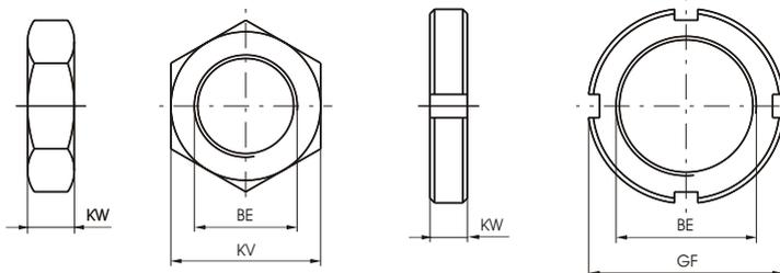
Servono a bloccare flange o piedini alle testate del microcilindro. I dadi sono montati sui diametri che vanno dal Ø16 al Ø 25, le ghiere sul 32 ed entrambi vengono forniti di serie (1 pezzo) sui microcilindri.
