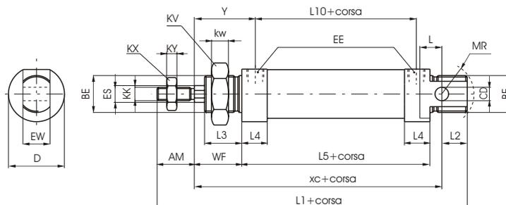
Uguale per dimensioni d'ingombro al tipo base 1260, si differenzia per adozione dello stelo esagonale anzichè tondo, per impedirne la rotazione. Particolarmente adatto nelle applicazioni dove sia necessario che lo stelo faccia da guida e supporto all'elemento collegato. Da non usare per frequenze troppo elevate e corse lunghe. Si preferisca, ove possibile il tipo a molla anteriore.
