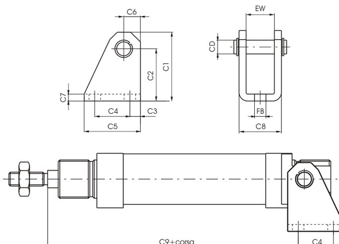
Questo fissaggio, montato sulla testata posteriore di un microcilindro in esecuzione base, permette un ancoraggio su un piano sia ortogonale che parallelo, con possibilità di oscillare e di autoallinearsi con l'elemento collegato allo stelo. Necessario quando non si ha la garanzia che lo stelo non subisca disassamenti durante la fase di andata e ritorno. E' costruito in acciaio tranciato e piegato e protetto contro la corrosione con cataforesi.
