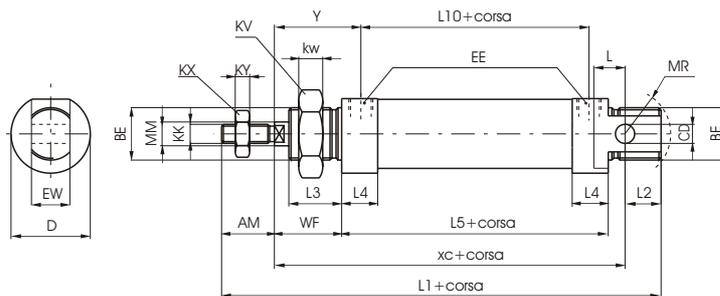
Esecuzione standard, perfettamente conforme alle norme ISO. Accetta tutti i tipi di ancoraggio previsti. Per i tipi a semplice effetto la corsa massima è di 50 mm., oltre la quale gli ingombri aumentano in lunghezza in maniera non proporzionale alla corsa (e comunque non oltre corsa 100).
