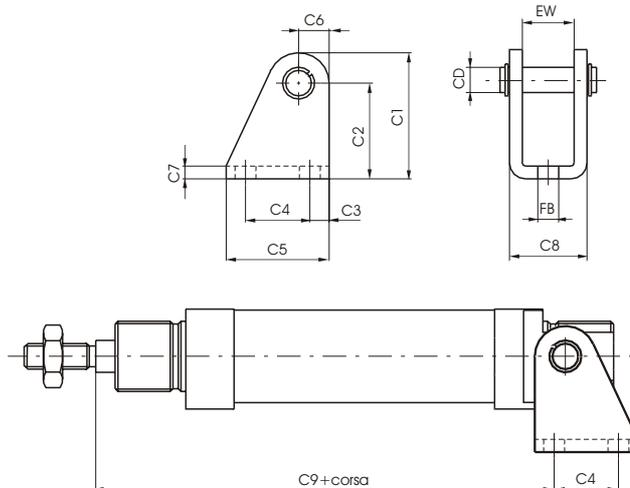
Questo fissaggio, montato sulla testata posteriore di un microcilindro in esecuzione base, permette un ancoraggio su un piano sia ortogonale che parallelo, con possibilità di oscillare e di autoallinearsi con l'elemento collegato allo stelo. Necessario quando non si ha la garanzia che lo stelo non subisca disassamenti durante la fase di andata e ritorno. E' costruito in acciaio inox 304 tranciato e piegato.
