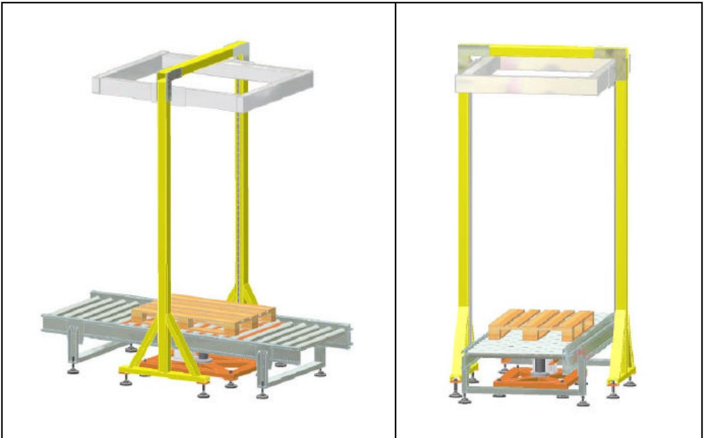
La macchina è costituita da due colonne sulle quali scorre un quadrilatero con i sensori di misura. Il pallet viene arrestato nel punto di misura; il quadrilatero si abbassa fino ad allineare le fotocellule di misura al pallet. Il quadrilatero inizia a sollevarsi per eseguire la scansione del profilo del prodotto sul pallet.
