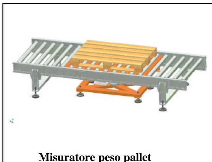
Il misuratore è utilizzato per la misura del peso di pallet che si muovono su rulliere o trasportatori a catena. La misura viene effettuata con il pallet fermo. Tra i rulli del trasportatore viene inserita una serie di profili. I profili si sollevano, sollevando il pallet. Con una cella di carico viene effettuata la misura del peso. Il peso massimo rilevabile è di 15000 N (1500 Kg). Il sollevamento è realizzato con un cilindro pneumatico.
