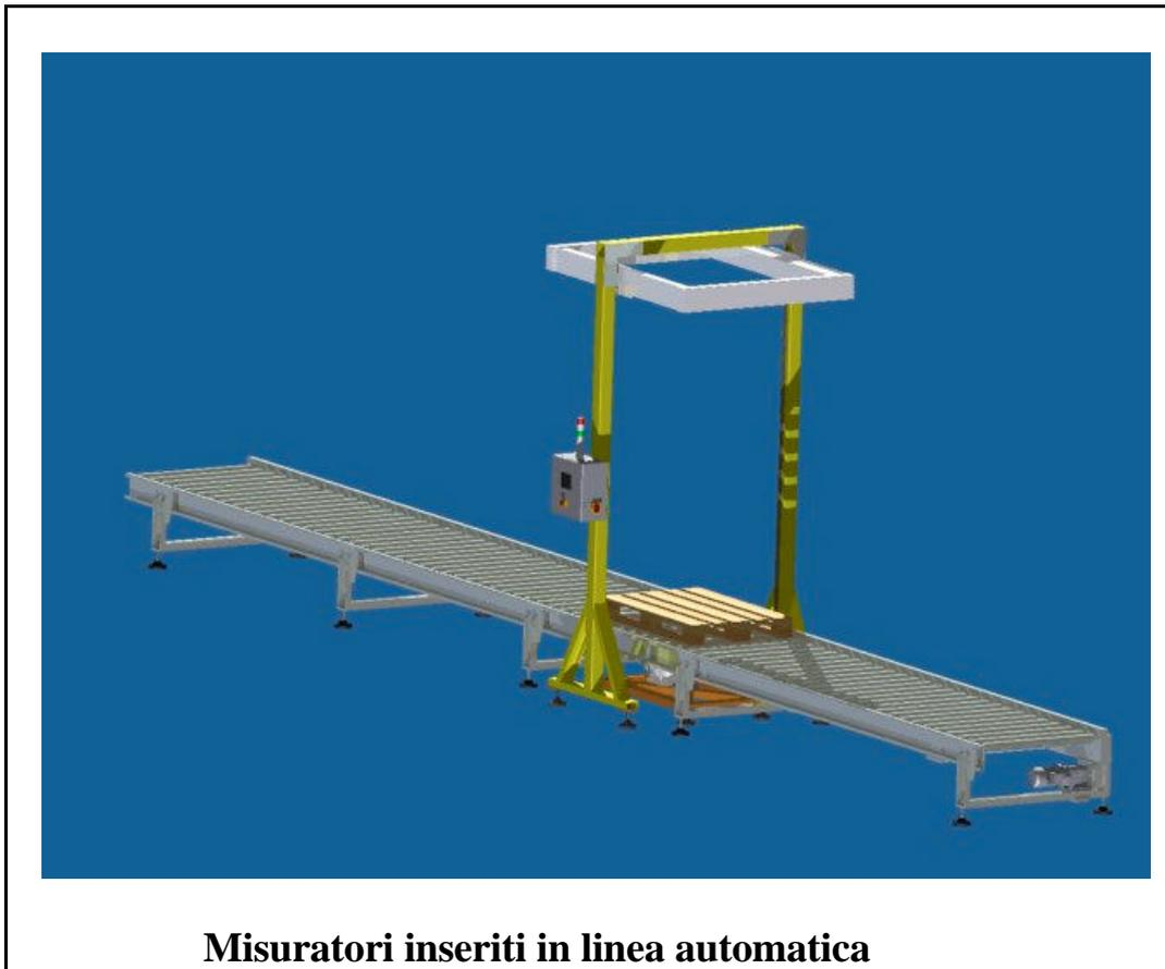
Il misuratori possono essere forniti con una linea automatica di trasportatori. La linea sopra riportata è costituita da 3 rulliere: una rulliera su cui vengono appoggiati i pallet da misurare (3 europallet su una lunghezza di 5,4 m), una rulliera inserita nel gruppo di misura ed infine una rulliera d'uscita su cui vengono parcheggiati i pallet misurati.
