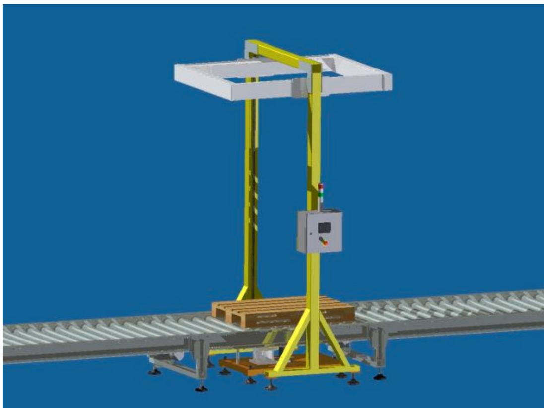
Nella figura sopra riportata, gli elementi in giallo sono il gruppo di misura delle dimensioni ed in arancione abbiamo il sistema di misura del peso
