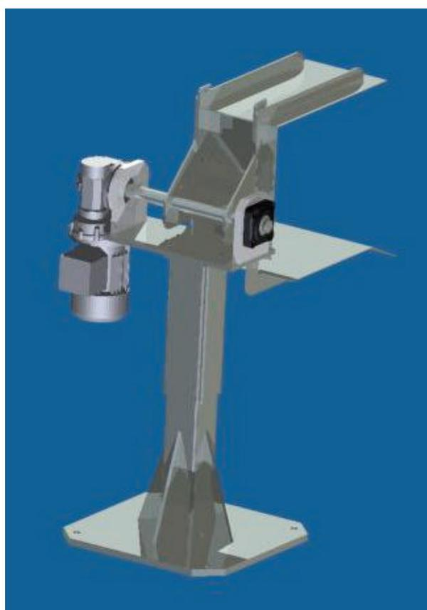
Utilizzati all'interno dell'area operativa del pallettizzatore. Possono ribaltare scatole e fardelli provenienti da nastri trasportatori a tappeto tessile o modulare, trasportatori a tapparelle oppure rulliere.
